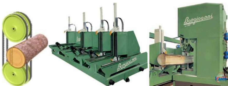
Рис. 12. Схема работы, зажимная каретка и вертикальный ленточнопильный станок TANDEM SNT 1400-1600 с гидрокареткой CRL (Bongioinni, Италия).
