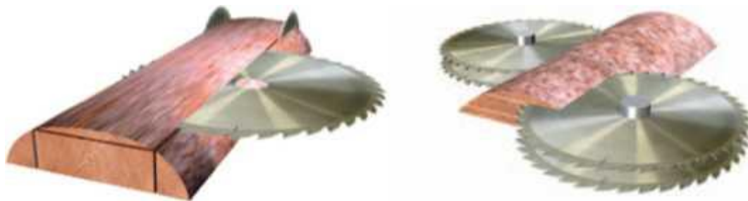
Рис. 33. Схемы работы горбыльных станков Walter (Польша)
