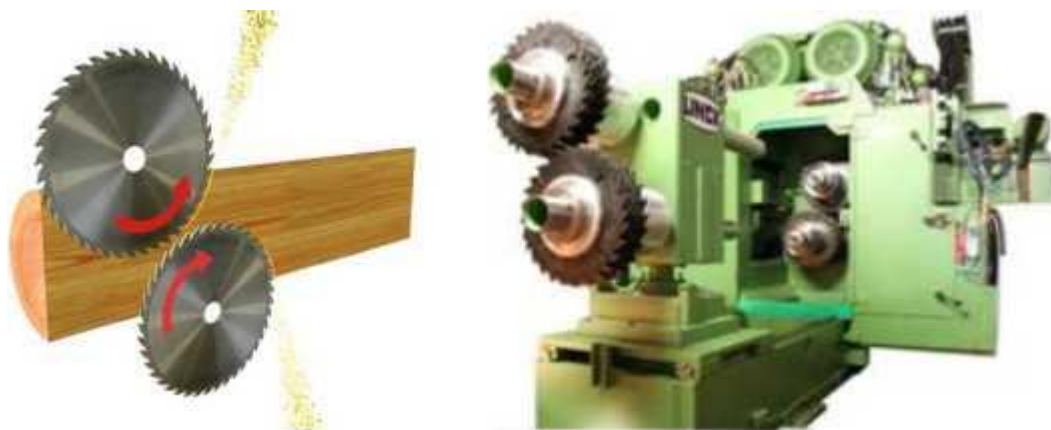
Рис. 18. Схема расположения пил в двухвальном станке и вид пильного узла брусующего станка (Linck, ФРГ)
