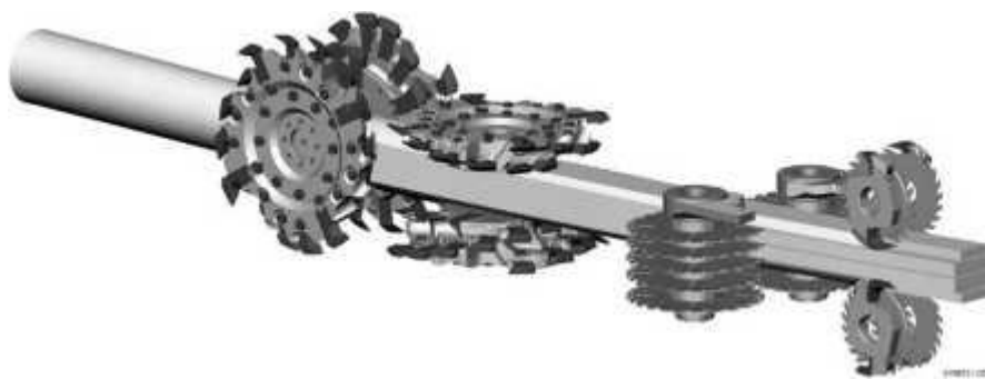
Рис. 27. Схема фрезерно-профилирующего станка HewSaw R200 (Veisto, Финляндия)
