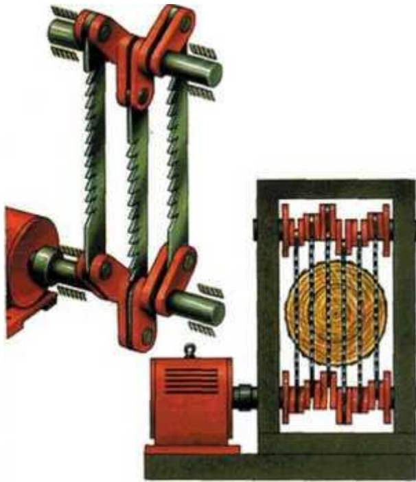
Рис. 6. Принципиальная схема многопильного станка с круговым поступательным движением рамных пил
