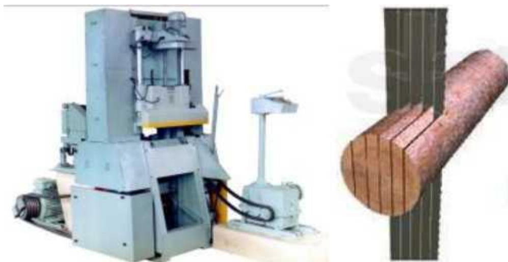
Рис. 3. Лесопильная рама одноэтажная Р63-4Б и схема ее работы (Даниловский ЗДС)
