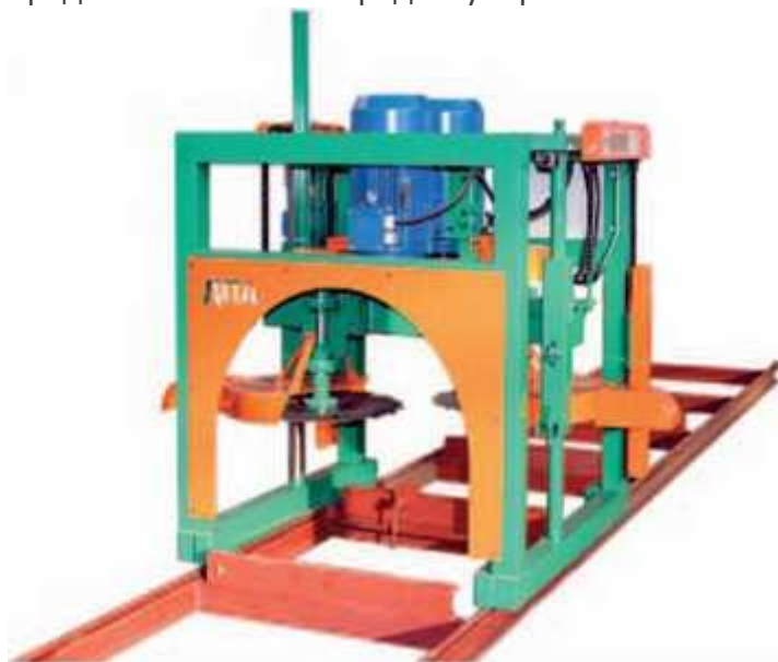
Рис. 20. Двухдисковый горизонтальный станок АЛТАЙ ДПА (Алтайлестехмаш, РФ) Вместо ленточной пилы здесь установлен механизм резания с двумя пилами в одной плоскости. Это несколько увеличивает пропил, но позволяет значительно увеличить ресурс работы пил, упростить обслуживание и поднять производительность станка. Заточку пил проводят не более одного раза в смену.
