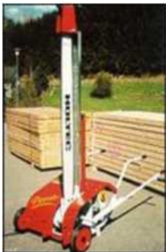
Рис. 35. Цепно-пильные станки для пакетов пиломатериалов: передвижной с качающейся пильной шиной (Holtec, Германия) и стационарный ПТ-1250 (КАМИ, РФ)
