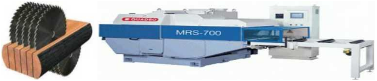
Рис. 22. Схема работы и общий вид многопильного двухвального станка MRS700 для распиловки бруса (Quadro, Тайвань)
